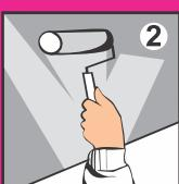
Обработайте основание грунтовочными составами БОЛАРС, соответствующими Вашему типу поверхности. Участки, пораженные плесневыми грибами, обработайте фунгицидным грунтом БОЛАРС «Антиплесень».
