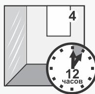
Загрунтованную поверхность оберегайте от попадания пыли. Дальнейшие отделочные работы рекомендуется выполнять через 12 часов после нанесения грунта.
